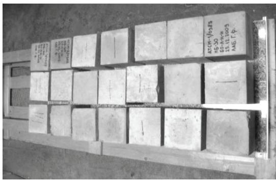
Slika 7. - Ispitivanje nosivosti kamenih ploča od granita[13]
